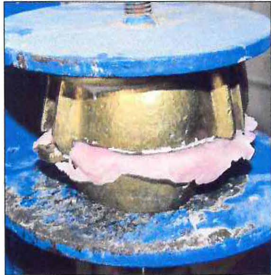
Imagen 4. Prensado del acrílico de termocurado
