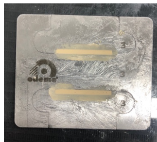
Figura 22. Moldes de precisión con material producido y depositado en placas
