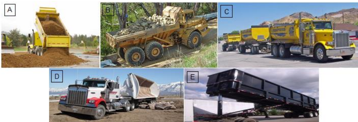
Figura 4-12 Tipos de camiones de volteo Fuente: TAUROREMOLQUES (2017)
