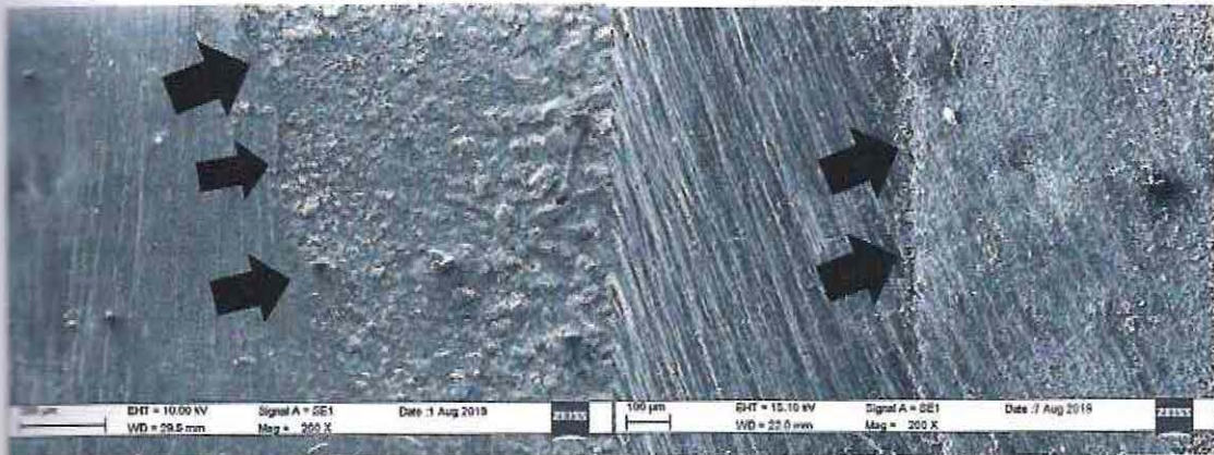
Figura 18- Imagen SEM 200x de presencia de brecha en margen de Biodentine.
