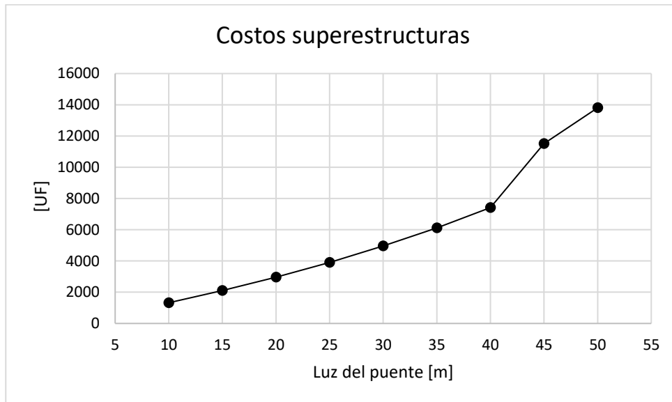
Figura 68: Costo óptimo de superestructuras de puentes de tramo simple
