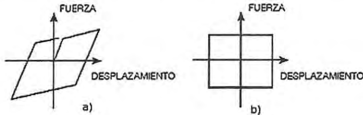
Figura 9 Curva fuerza-deformación dispositivos histeréticos a) Metálico, b) Friccional [12].
