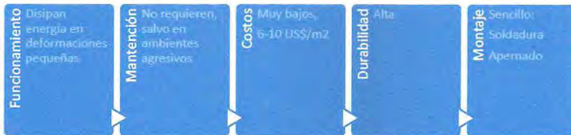
Figura 14 - Ventajas de disipación de energía histerético ADAS. [15].
