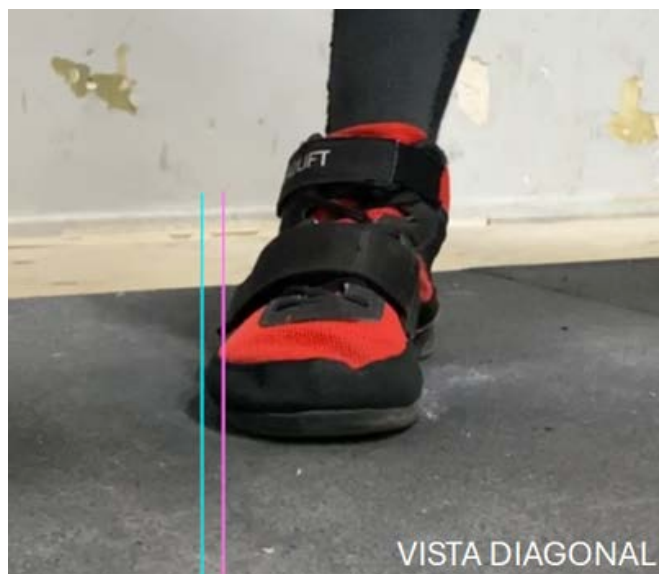
Figura 30: Fotografías que dan cuenta del desplazamiento lateral producido por la aplicación de fuerza lateral. Fuente: Capturas de video propio.
