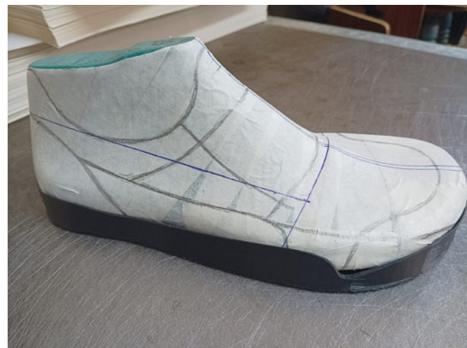
Figura 89: Patronaje de calzado especializado para powerlifting. Fuente: Fotografías por Luis Parra.
