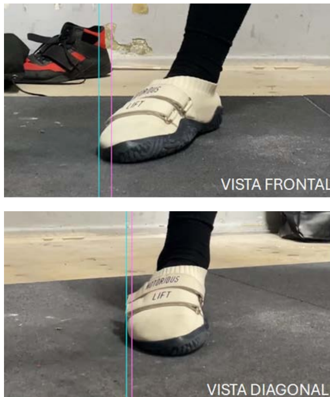
Figura 29: Fotografías que dan cuenta del desplazamiento lateral producido por la aplicación de fuerza lateral. Fuente: Capturas de video propio.
