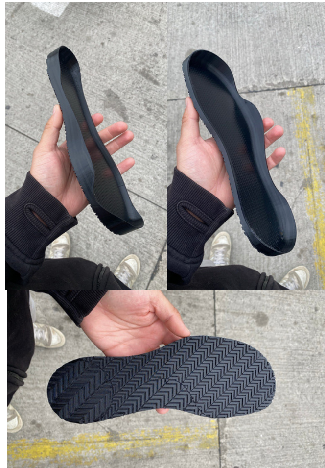
Figura 85: Resultado de impresión 3D de primer prototipo Fuente: Fotografías propias
