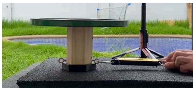
Figura 78: Vista lateral de todos los materiales usados para la medición de coeficiente de roce. Fuente: Fotografía propia
