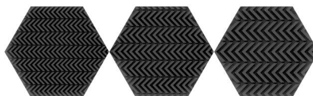
Figura 83: Modelado 3D de bases con variables de patrón en espiga. Fuente: Elaboración propia
