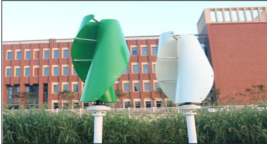
Figura 41: Disposición mínima de 1,0 metro, entre Aerogeneradores verticales.
