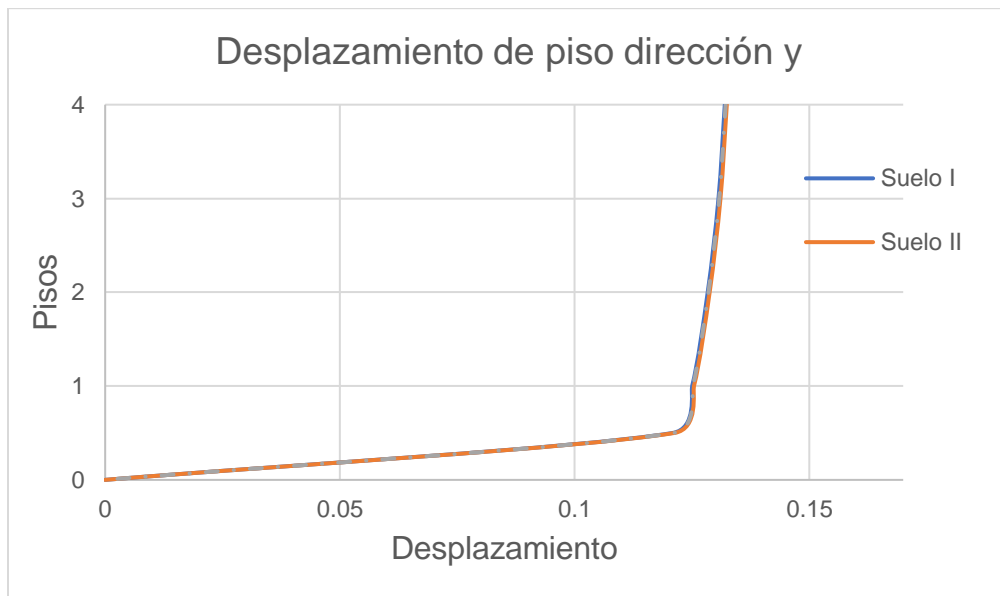
Figura 3.34. Desplazamiento en el centro de masa en dirección y de la estructura para cada tipo de suelo
