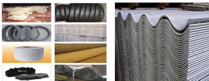
Imagen 1: Materiales con asbesto
