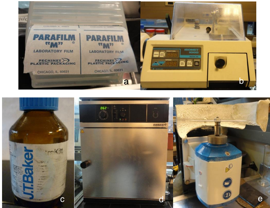
Figura 22. a) Película para sellado de laboratorio Parafilm M ® , SPI Supplies b) Máquina cortadora IsoMet ® 1000, BUEHLER c) Resina de montaje UltraKitt, J.T.Baker ® d) Estufa Universal, UM 500, MERMETT e) Máquina de desgaste.
