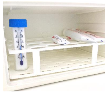
Figura 15. Horno a 37° C con tubos de tratamientos (peróxido de hidrógeno al 35% y peróxido de hidrógeno al 35% con fluoruro de sodio al 5%).
