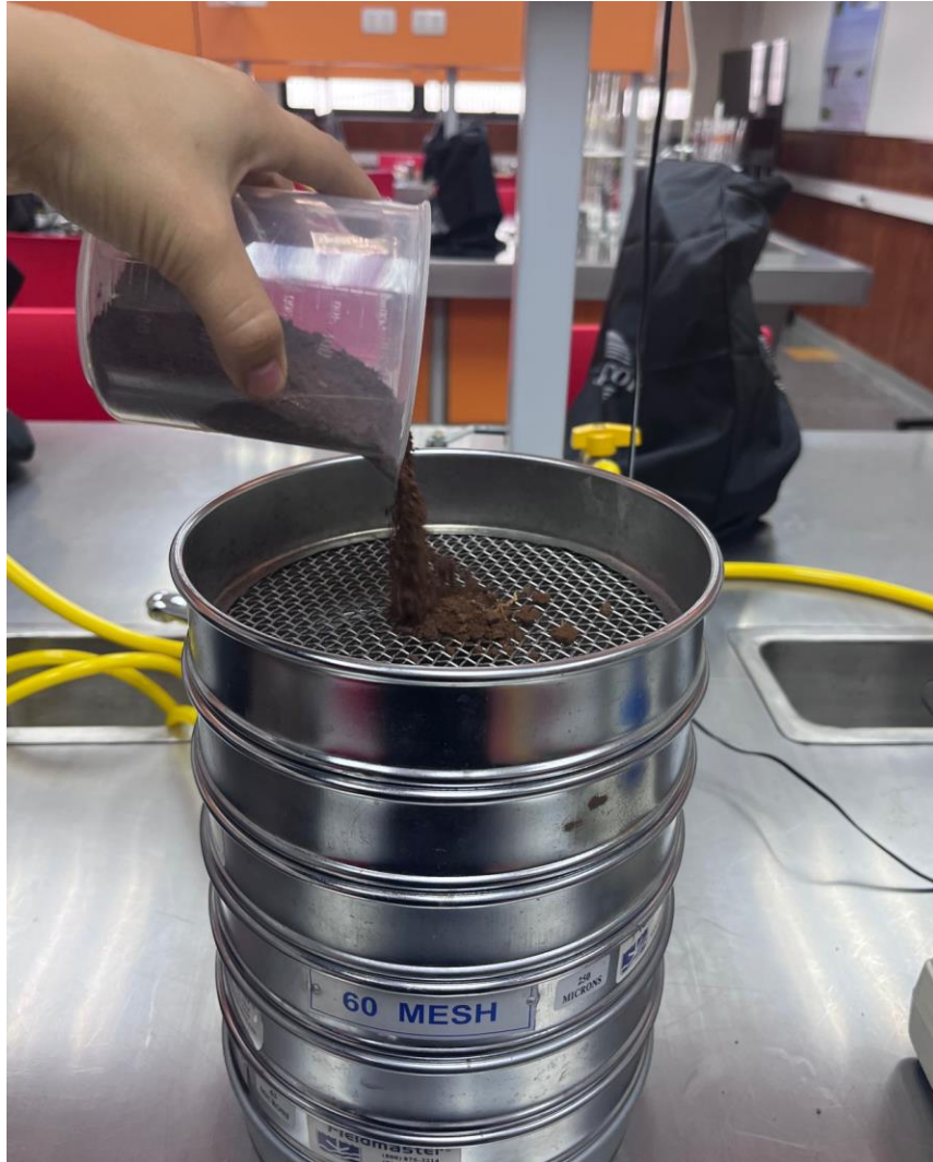
Figura 4.3. Proceso de tamizado de suelo para análisis granulométrico
