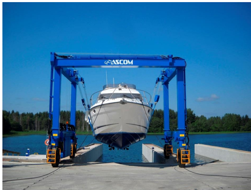
Figura 10: Maquinaria “Travel Lift” utilizada para embarcaciones náuticas. Fuente: Nautixespo – Salón Online Náutico y del Sector Marítimo 15 .
