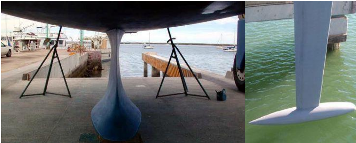
Figura 12: Ejemplos de “Quillotes” de embarcaciones deportivas. Fuente: Empresa Fondear 17 .
