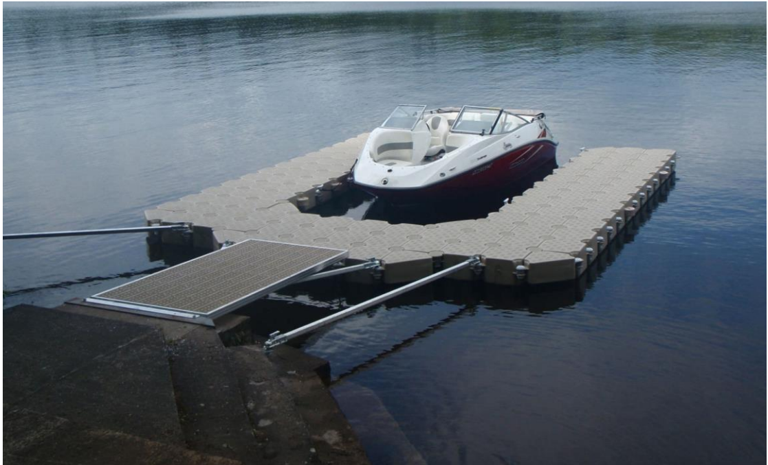
Figura 24: Ejemplo de estructura flotante de polietileno en forma cubos Fuente: Nautixespo – Salón Online Náutico y del Sector Marítimo 21
