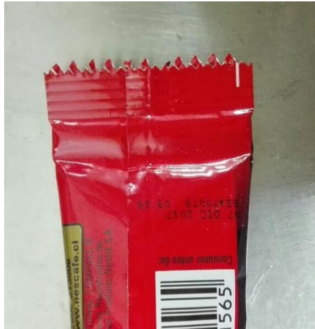
Figura 7.18 - Marca sobre nivel de sellado.
