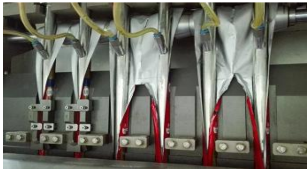
Figura 7.30 - Ruptura de laminado por corcha de fabricante.
