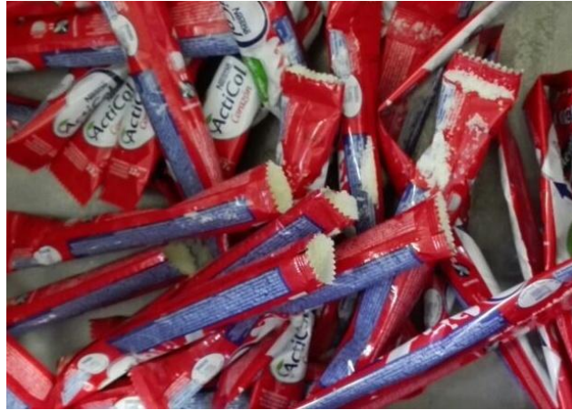
Figura 7.14 - Desfase de corte en sobres.
