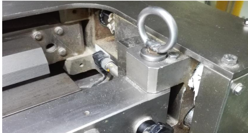
Figura 7.6 - Zona vertical horizontal y puntos de lubricación.
