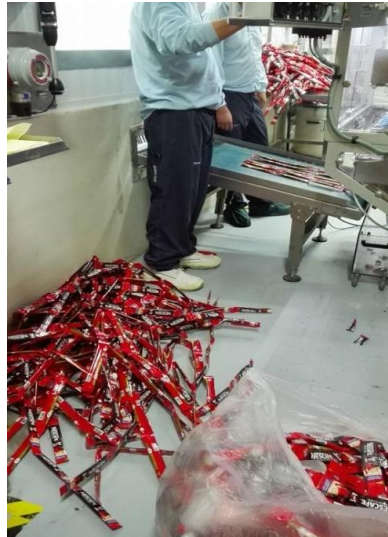
Figura 7.28 - Pérdida de laminado por ajustes mencionados.
