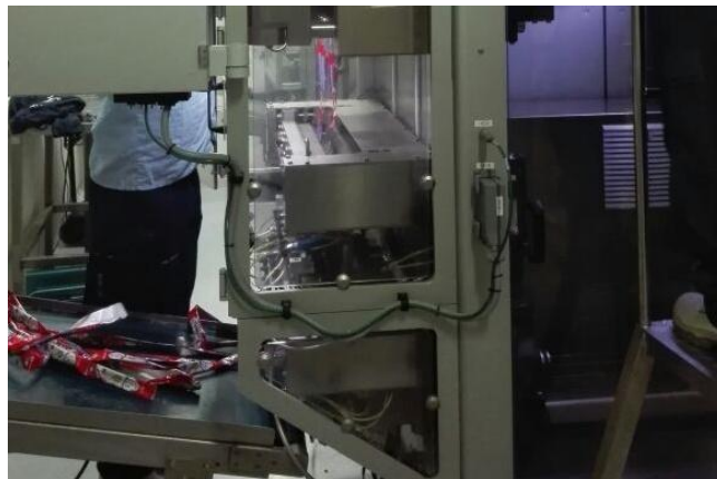
Figura 7.13 - Atascamiento de sobre en la zona de cuchillos.
