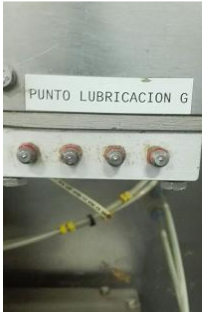
Figura 7.11 - Manguera desconectada en punto de lubricación.
