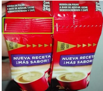
Figura 7.29 - Pre picado inexistente en unión de stick.
