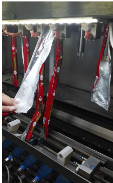
Figura 7.24 - Ruptura de laminado.
