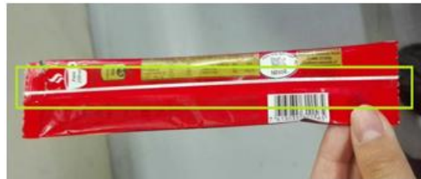
Figura 7.26 - Desfase de laminado de stick.
