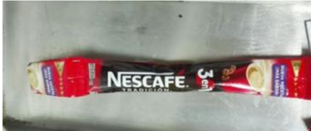
Figura 7.19 - Desfase de corte en sobre.
