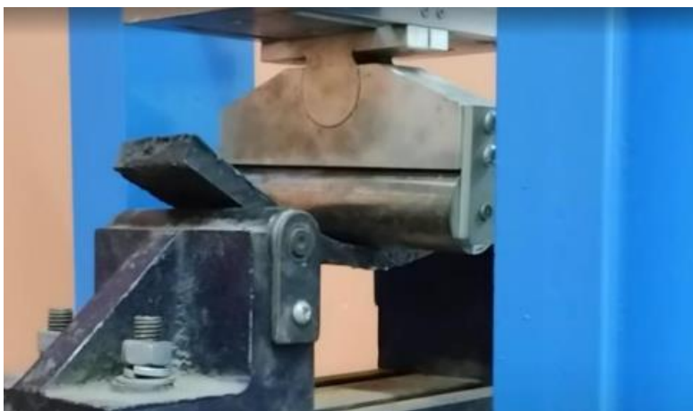
Figura 4.8 Ensayo de resistencia a flexión en probeta de 30% HDPE y 70% PP
