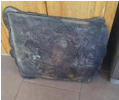
Figura 4.2 Marco atrapado por la mezcla
