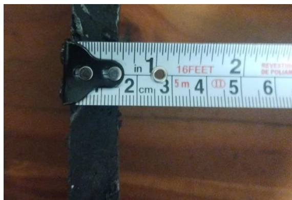
Figura 4.3 Aumento de espesor en paneles
