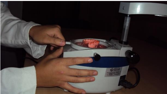
Figura 12: Estampadora PLASTVAC P7 Bio Art con lámina coloreada en posición para el procedimiento de estampado.
