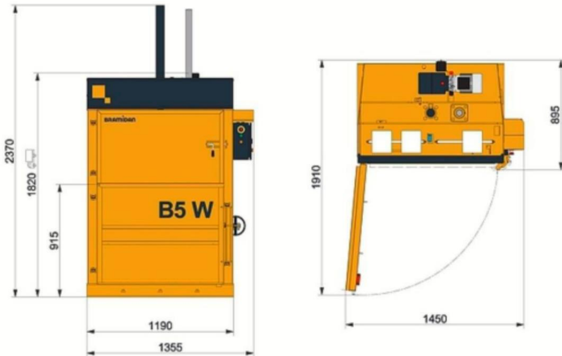
Figura N°28: Dimensiones en mm, compactadora B5W Fuente: Compactech
