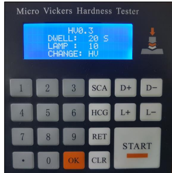
Fotografía 4 y 5: Máquina de microdureza de Vickers con muestra en posición y datos ingresados a la máquina
