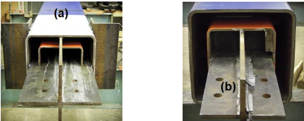
Figura 2.51 – Extremos de la riostra SC-BRB, (a): extremo izquierdo, el tubo medio está soldado al núcleo de acero, (b): extremo derecho, el tubo exterior está soldado al núcleo de acero [61]
