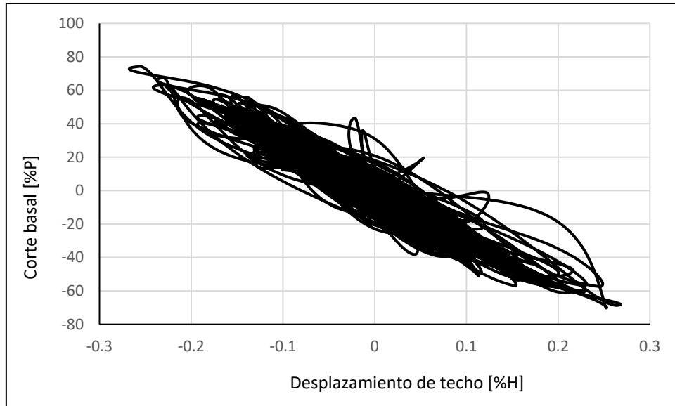
Figura 5.33 – Corte basal vs Desplazamiento de techo, sistema BRBF – Concepción – dirección de análisis Y
