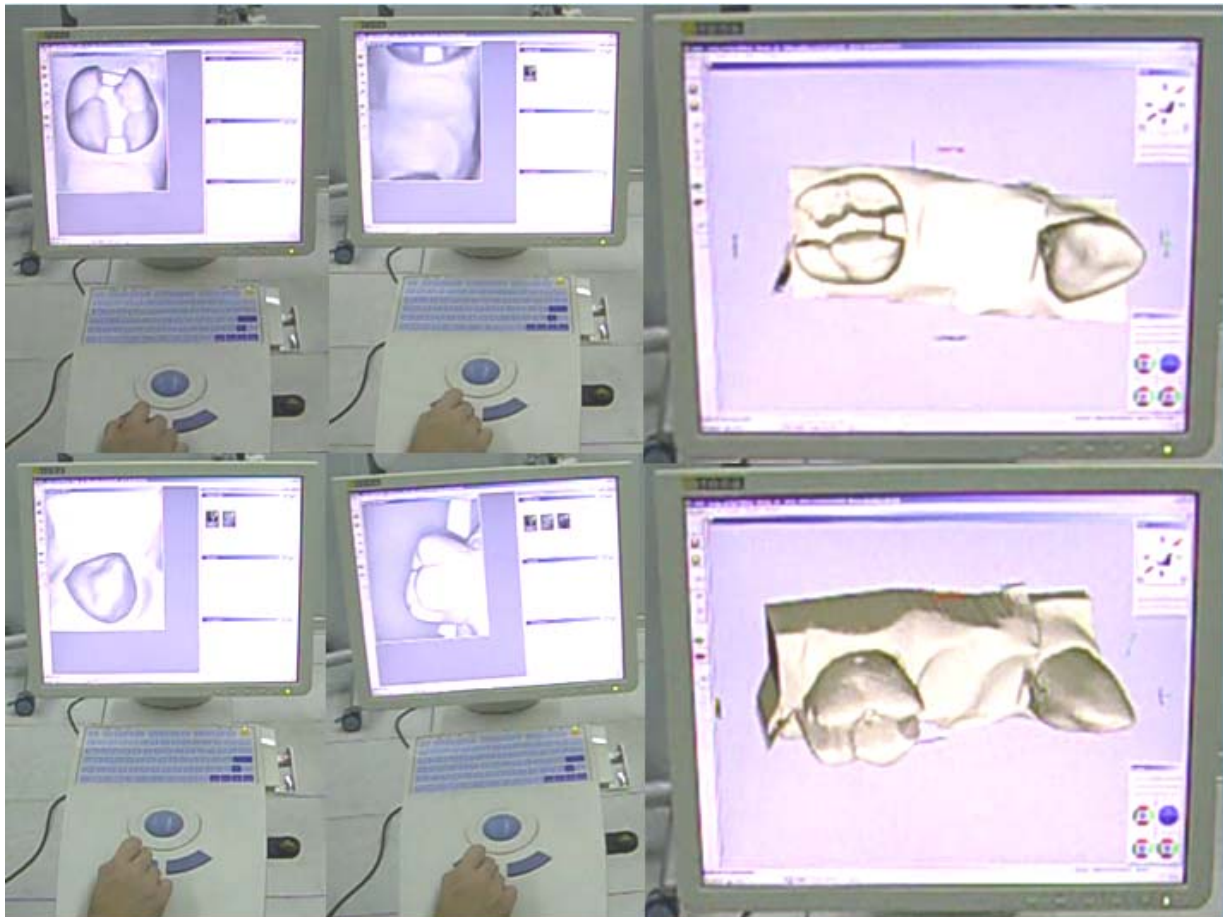
Figura 13: Digitalización de los modelos mediante el Sistema de CEREC 3®
