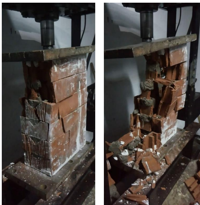
Figura 4.13: Prismas en el momento de la rotura
