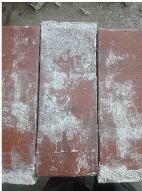
Figura 4.5: Probeta ensayo de adherencia Fuente: Elaboración propia (2017).
