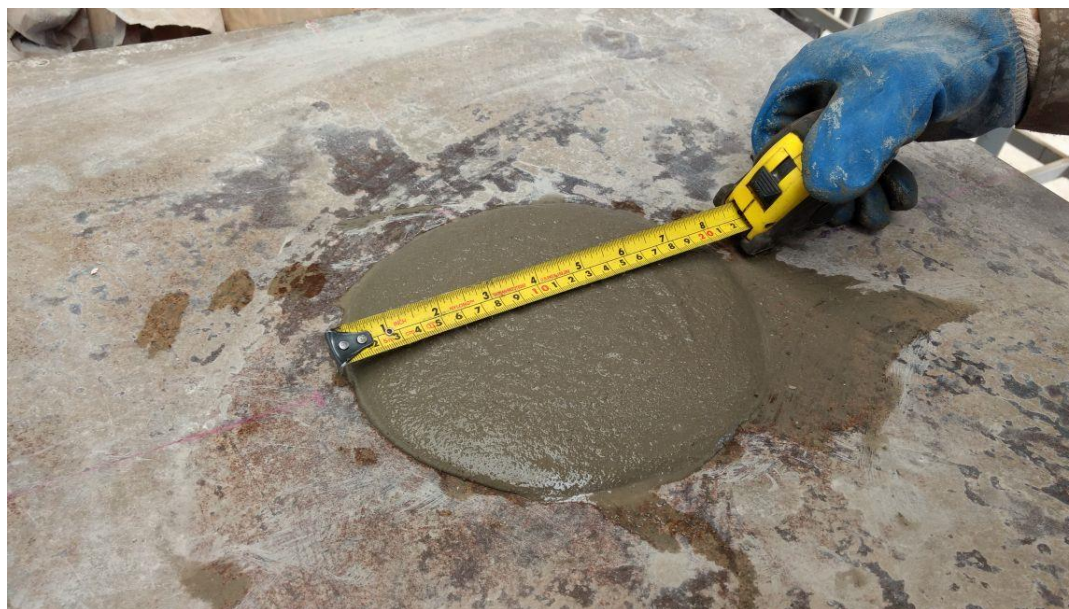
Figura 8.8: ensayo mesa de sacudida
