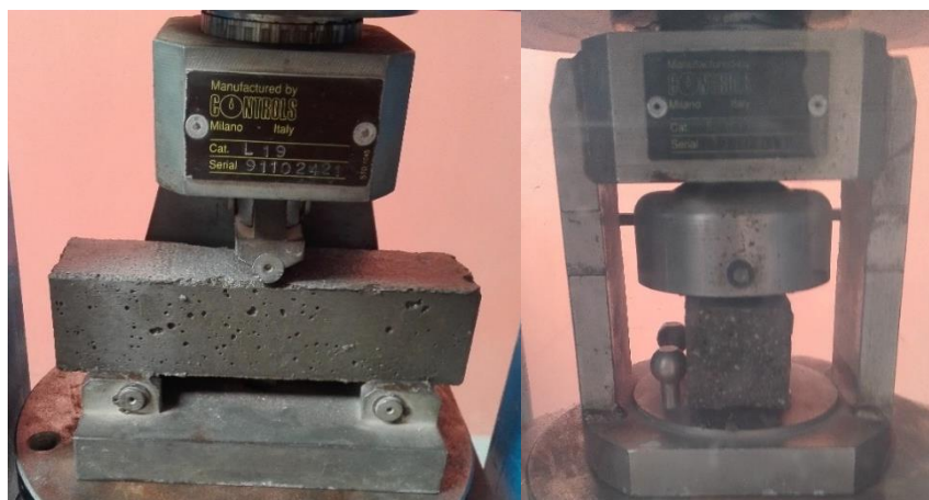
Figura 8.7: Ensayo de flexión y compresión de mortero
