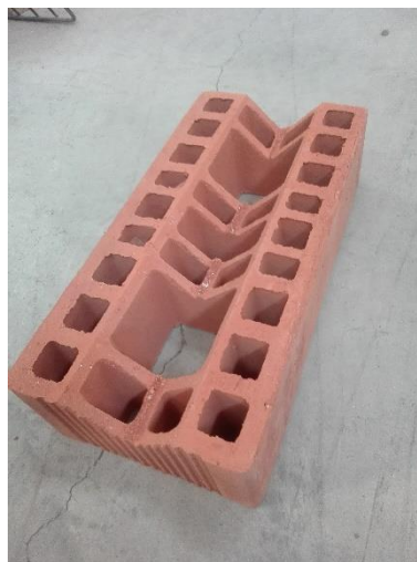
Figura 3.2: Ladrillo 7E con rebaje triangular.
