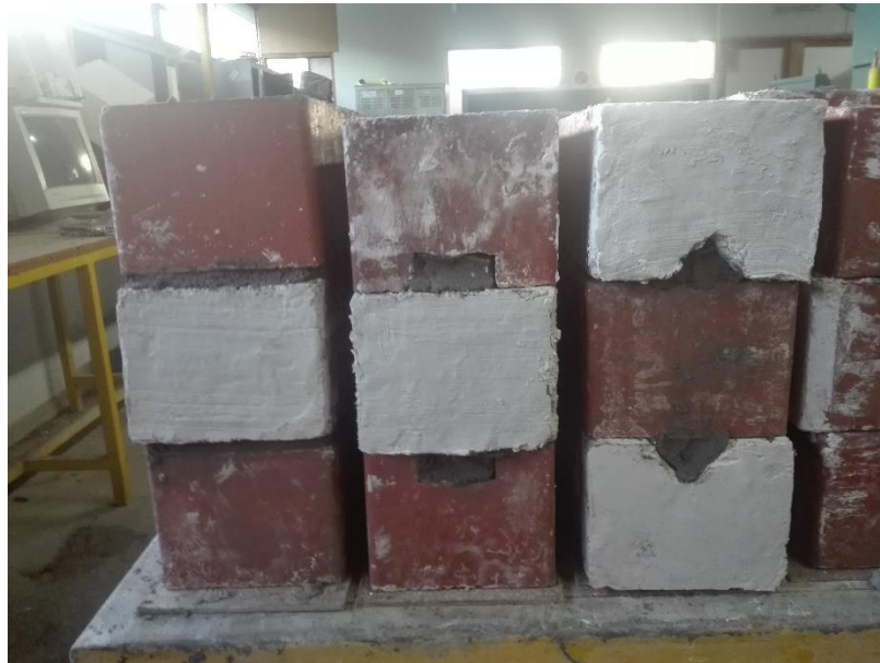
Figura 4.4: Probeta de ensayo de adherencia de cizalle.
