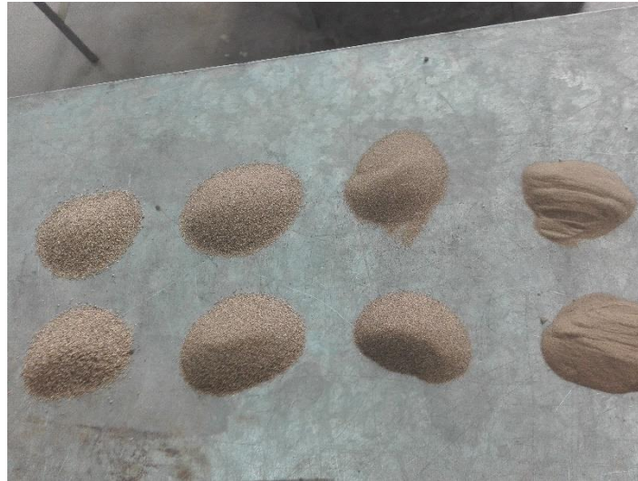
Figura 8.4: Ensayo de granulometría (Arena Dmax 1,25 mm)
