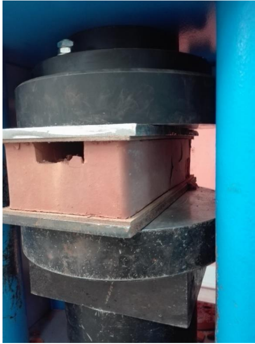
Figura 4.2: Rotura ladrillo 7E con rebaje rectangular, ensayo de compresión
