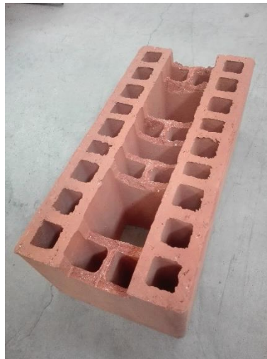
Figura 3.4: Ladrillo 11E con rebaje rectangular
