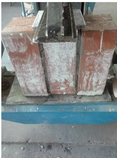
Figura 4.6: Ensayo de adherencia de cizalle con ladrillo 11E Fuente: Elaboración propia (2017).
