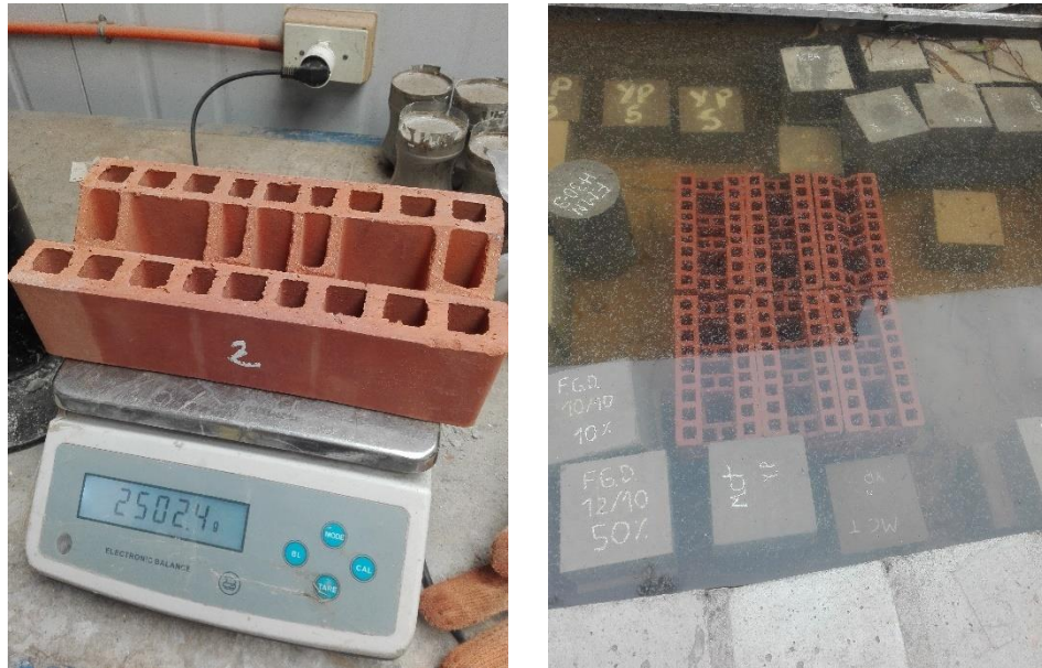
Figura 4.3: Ensayo de absorción
