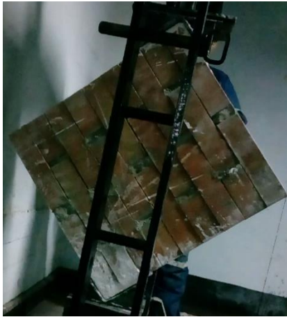
Murete sin falla
