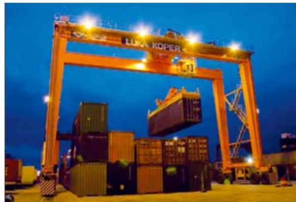
Grúas Pórtico sobre neumáticos (RTG)
