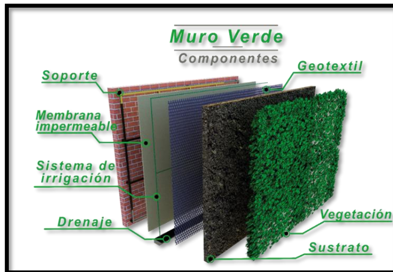
Figura 2.12: Componentes de una fachada verde típica.
