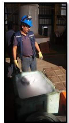
Preparación de enfriamiento de buje para su calaje.
