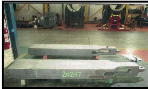
Ilustración 47: Picaporte 4340 y Picaporte al Manganeso Fuente: Empresa Forjados S.A.
