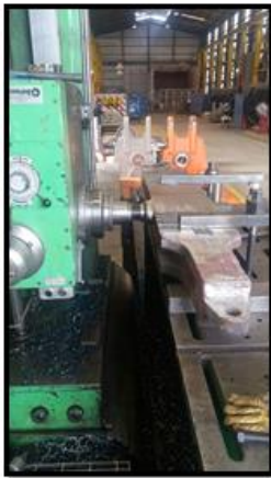
Mecanizado de un picaporte al manganeso.
