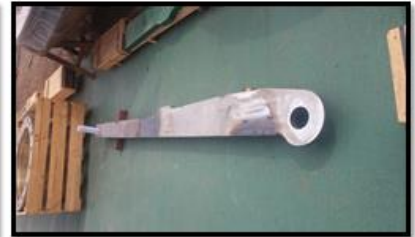
Recuperación por soldadura de un balancín.
