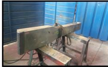
Recuperación por soldadura de un picaporte 4340.
