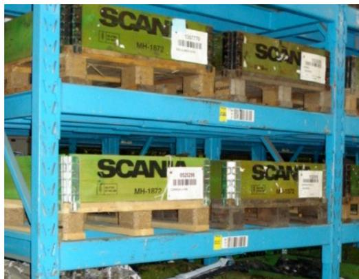
Figura 4.8: Rack para almacenamiento de repuestos pesados
