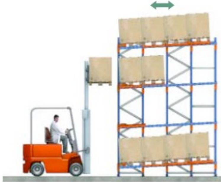
Figura 2.10: Esquema de paletización push-back
