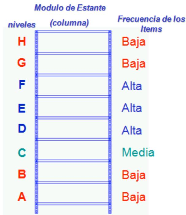
Figura 2.12: Esquema de almacenaje por frecuencia en columna.
