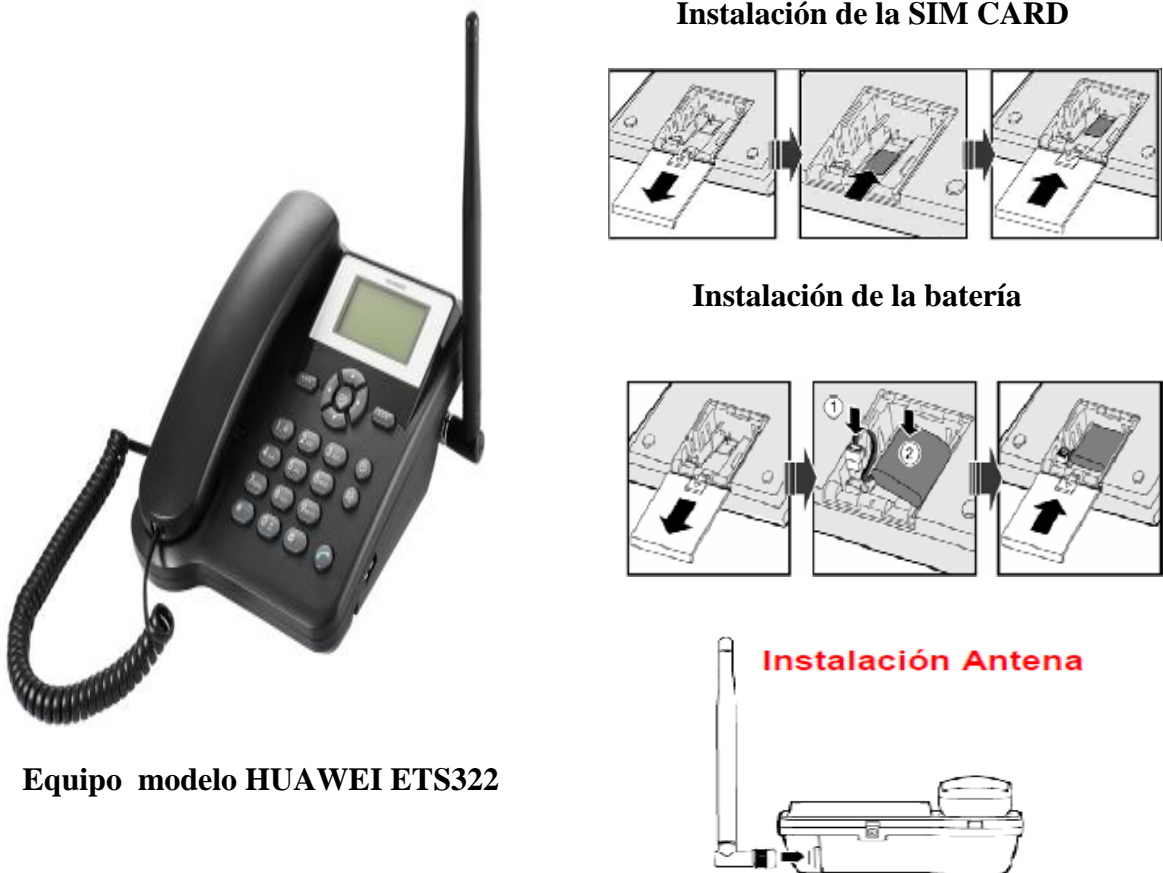
Figura N° 4.2: Características del equipo FWT
