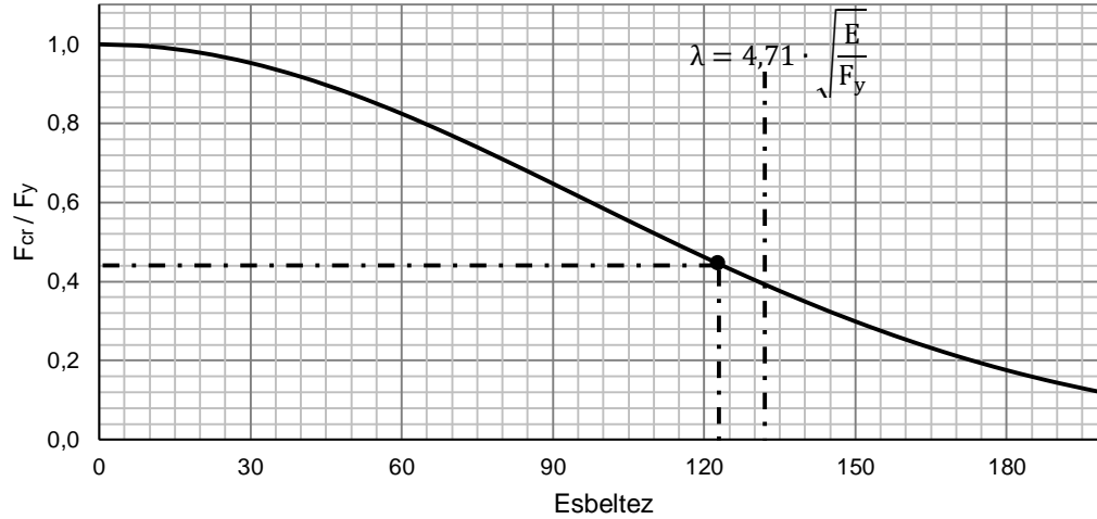
Grafico 4.1 Tensión crítica en función de esbeltez de la diagonal en el sistema tradicional
