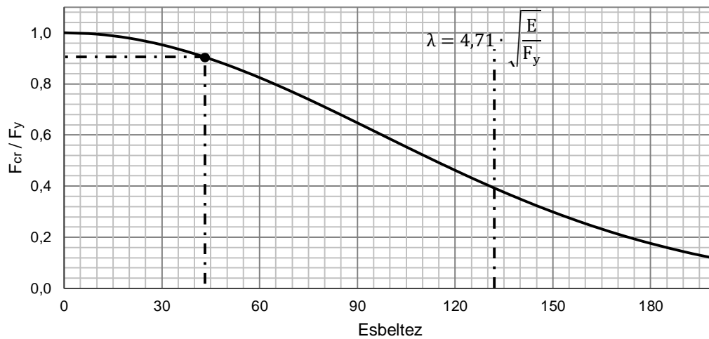
Grafico 5.1 Tensión crítica en función de esbeltez de la columna en el sistema con restricción al pandeo
