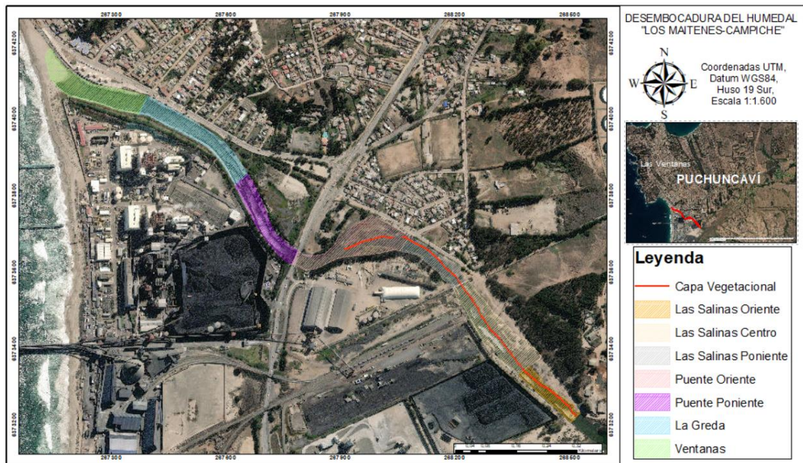
Figura 5.44: Georreferenciación de la propuesta de implementación de capa vegetacional en la ribera. Fuente: (Elaboración propia).
