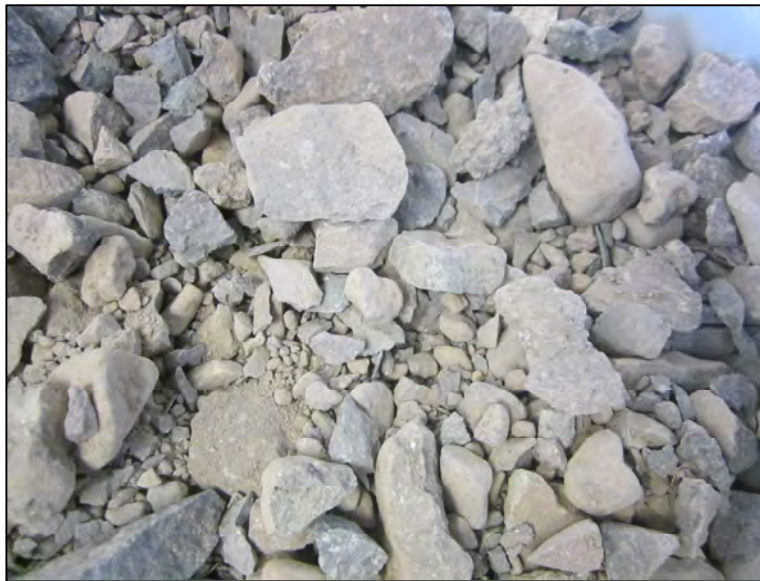
Figura 5.2: Fotografía a los Áridos de Base Granular TRICAM (elaboración propia)
