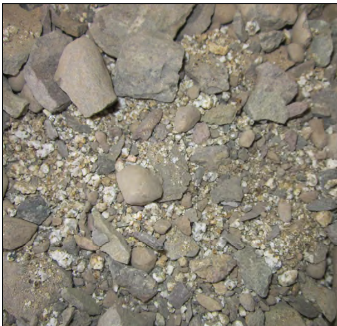
Figura 5.3: Fotografía a los Áridos de Base Granular TRICAM mezclados con Material Degradable. Para el ejemplo se utilizó una mezcla del 50% de ambos materiales (elaboración propia)
