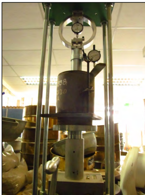
Figura 2.1- Imagen Máquina para determinar el Índice de CBR (elaboración propia)
