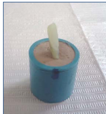
Figura 11. Unidad de estudio montada en acrílico en tubo de PVC.
