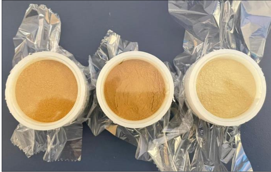
Figura 5.5 - Muestras de El Pangal, Camino La Quebrada y Cuncumén, respectivamente, para análisis FRX. Fuente: Elaboración propia.
