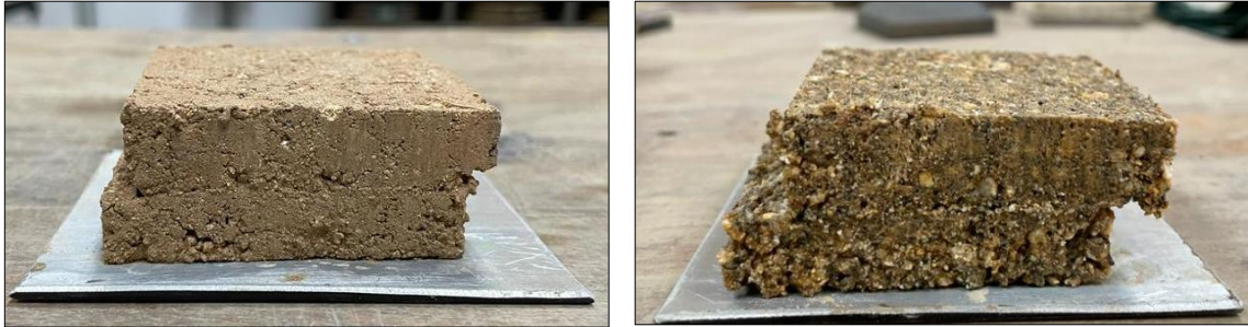
Figura 5.4 - Ensayo: Corte directo. Fuente: Elaboración propia.
