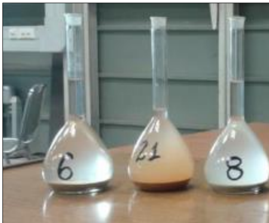
Figura 5.1 - Determinación de la gravedad específica mediante picnómetro. Fuente: Elaboración propia.
