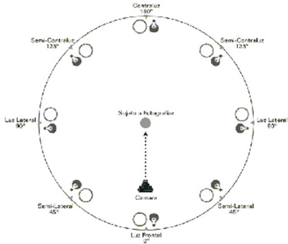
Figura 18: Esquema gráfico de las cinco posiciones de la luz que giran horizontalmente en torno al motivo a fotografiar.
