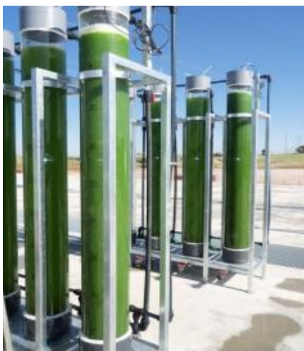
Figura 1.6: Fotobiorreactor cerrado tipo columna (Pariente, 2016).
