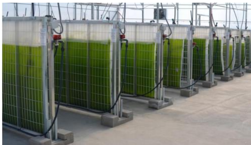
Figura 1.7: Fotobiorreactor cerrado tipo plano (Gegg et al. , 2017).
