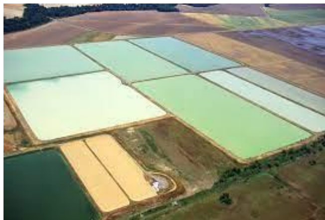
Figura 1.4: Fotobiorreactor abierto tipo open ponds (Pariente, 2016).
