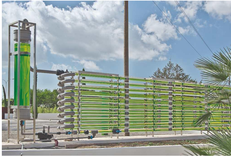
Figura 5.8: Fotobiorreactor tubular horizontal (Ibiza Botánico Biotecnológico, 2022).
