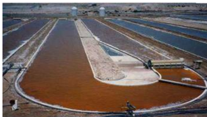
Figura 1.5: Fotobiorreactor abierto tipo raceways (Cerón, 2019).
