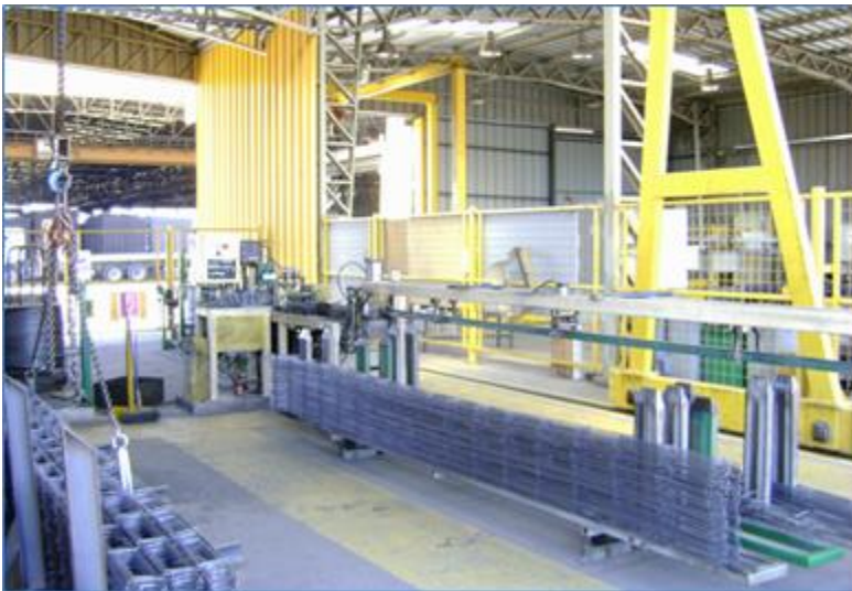
Figura 5 Maquina Electro soldadora Bergandi utilizada en el proceso de producción de escalerillas.
