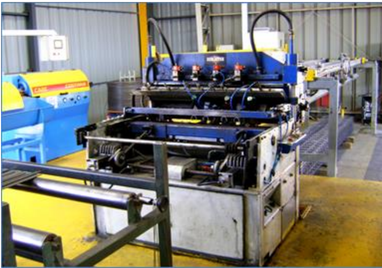
Figura 4 Proceso productivo de pilares y cadenas realizadas con la Maquina Electro soldadora PG-12 Schlatter
