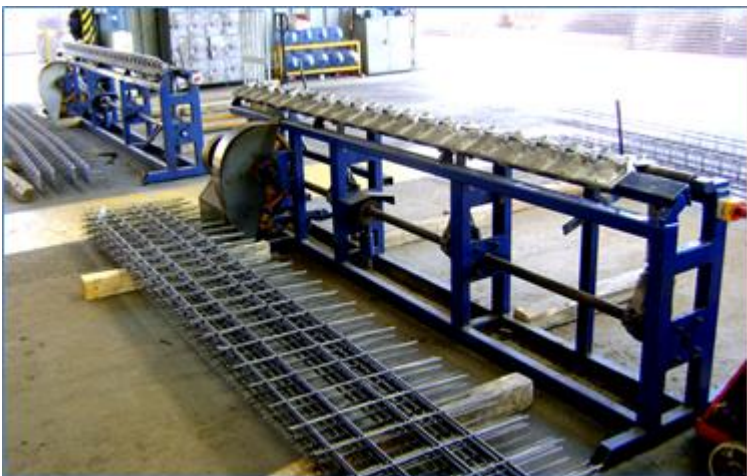
Figura 6 Máquinas Dobladoras utilizada dentro de los procesos finales de Pilares y Cadenas.
