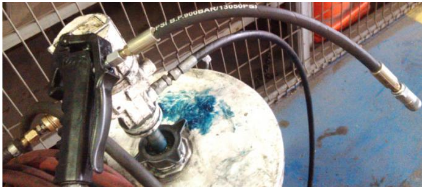
Figura 34 Dispositivo de engrase cambiado.
