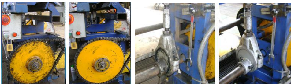
Figura 33 Proceso de limpieza de maquinarias dobladora.
