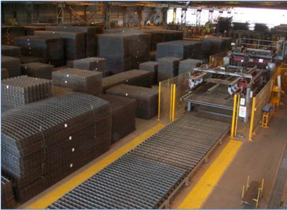
Figura 7 Área de producción de mallas con maquina Electro soldadora G – 32, EVG, fotografía facilitada por Armacero Matco S.A.
