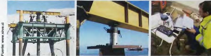
Fig. 2.4 - Ensayo de carga PDA (Pile Driving Analyzer) a pilote de prueba de Muelle Terquim, en Mejillones.
