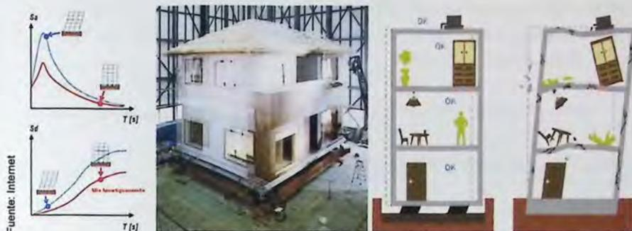
Fig. 2.11 - Ensayos muestran la respuesta de estructuras con y sin aislación basal.
