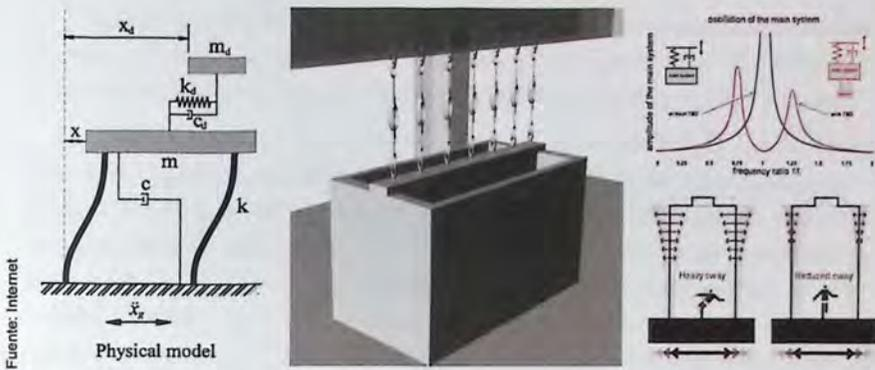
Fig. 2.14 - Características formales y de funcionamiento de un AMS.
