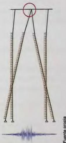
Fig. 4.3 - Vista de un eje transversal tipo (de M<sub>1</sub>), destacando el nodo central de donde se obtiene la información de las aceleraciones absolutas.
