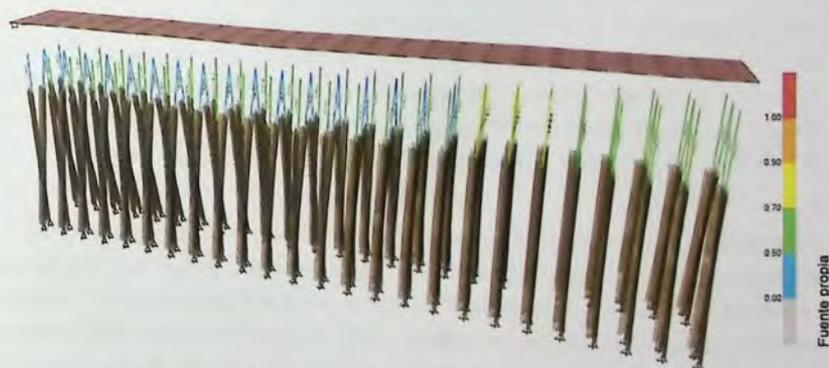
Fig. 4.8 - Vista típica de verificación de PMM de los pilotes en el programa SAP2000.
