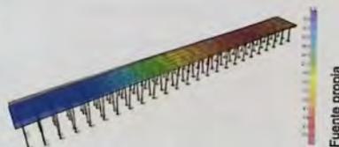
Fig. 4.1 – Análisis sísmico del muelle, en particular, visualización de los desplazamientos en el modo fundamental
