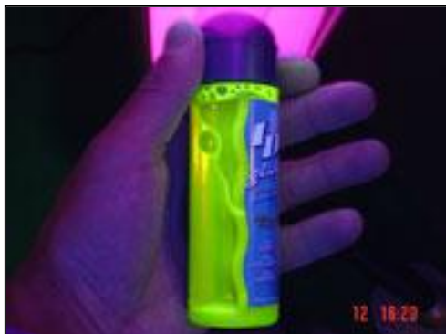
Fig. 16: Emisión fluorescente de compuesto químico estimulado con luz u.v. (Rubio, 2005).
