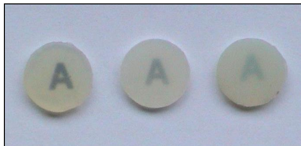
Fig. 11: Cuerpos de prueba de diferentes composites representando el fenómeno de transmisión (Rubio, 2005).
