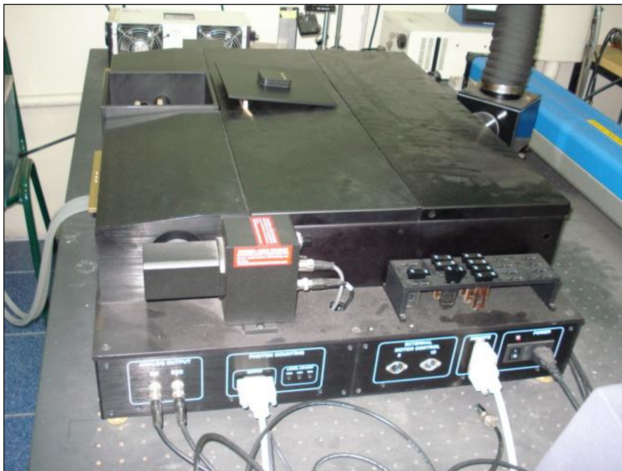
Fig. 19: Espectrofluorímetro ISS K2 del Departamento de Química y Ciencias Matemáticas de la casa central de la Pontificia Universidad Católica de Valparaíso (Carrasco – Ibáñez, 2007).
