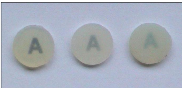
Fig. 10: Cuerpos de prueba de diferentes composites representando el fenómeno de transmisión (Rubio, 2005).
