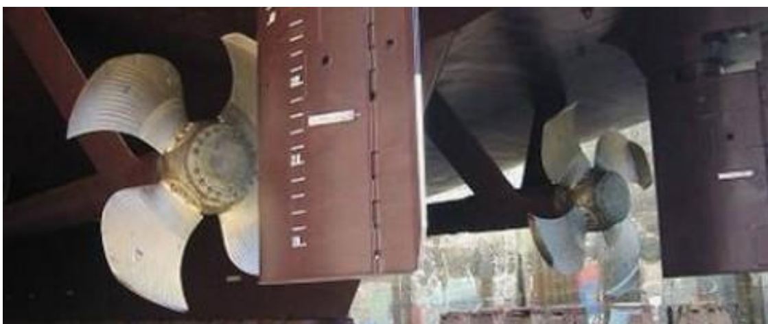
Figura 7. Hélice de puntas cargadas (Contracted and Loaded Tip -CLT- de SISTEMAR)
