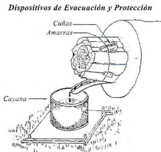
Figura 19: Esquema muestra la forma de extraer savia.
