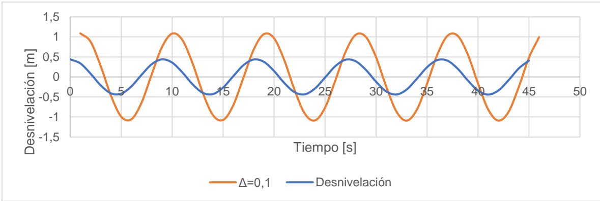
Gráfico 16: Movimiento respecto a la onda superficial - Flotador Rectangular N°4
