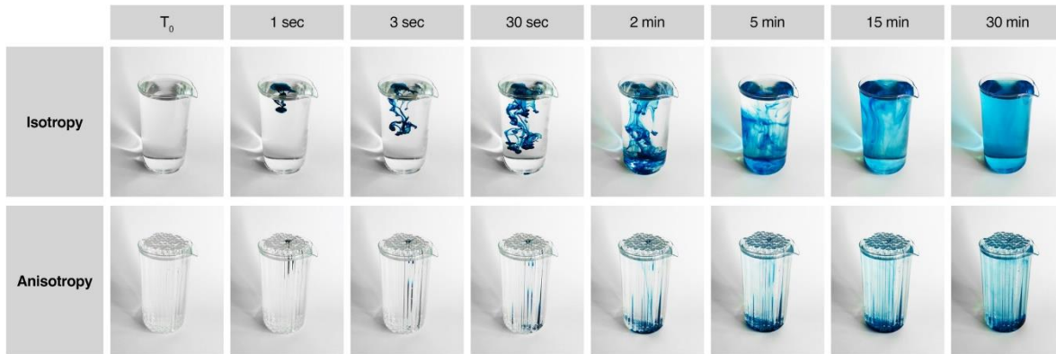
Figura 2: difusión isotrópica versus anisotrópica. En este diagrama, el vaso de precipitado lleno de agua (arriba) representa un sistema isotrópico; cuando se añade una gota de colorante azul al vaso, el colorante se difunde libremente en todas direcciones. En la fila inferior, el vaso contiene agua y barras acrílicas. Cuando se añade una gota de colorante, esta difunde en dirección vertical a lo largo de las columnas de agua entre las barras, pero su difusión horizontal es mucho más lenta. Se trata de un sistema anisotrópico. Extraído de Santos, L.A, et.al (2023). “Diffusion tensor imaging of the physis: the ABC’s” Pediatr Radiol 53, 2355–2368
