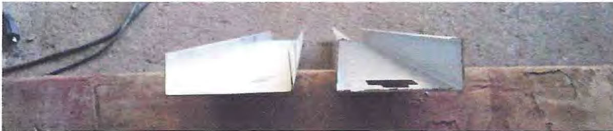
Figura 4.14- Perfiles C (U) y CA (C)
