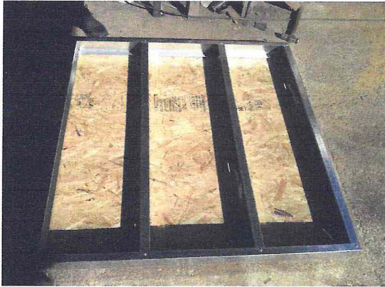
Figura 4.16- Panel sin diagonales
