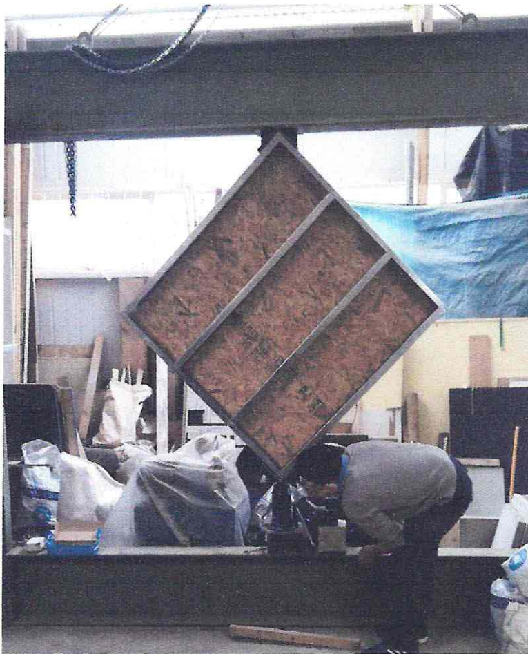
Figura 4.17- Panel sin diagonales montado en marco de carga
