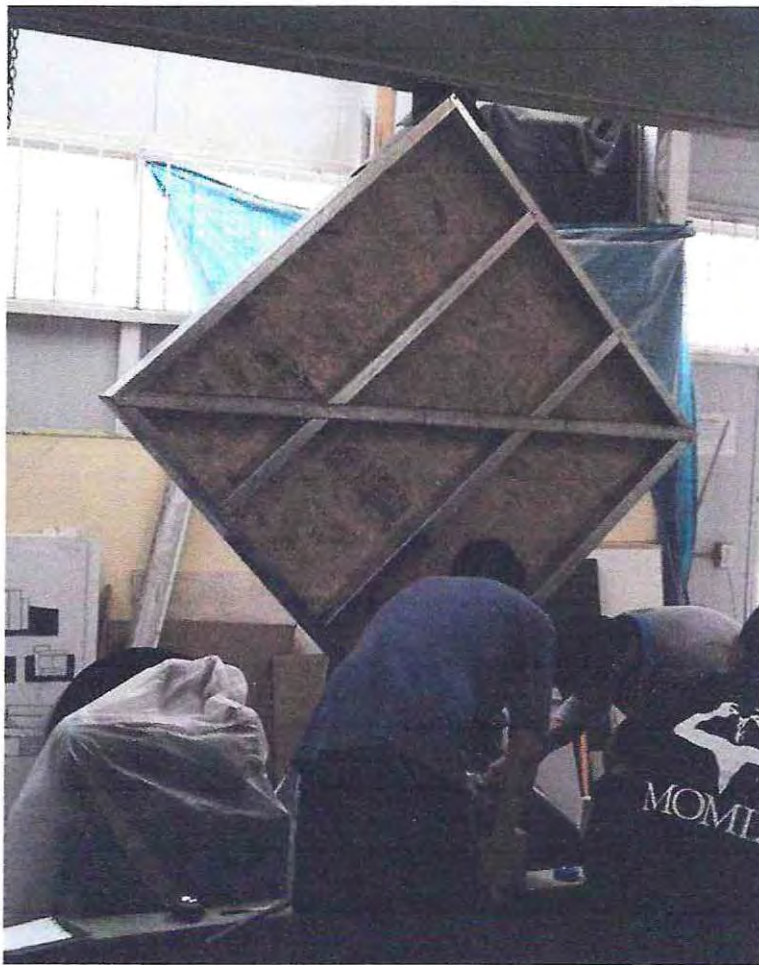
Figura 4.19- Panel con diagonales montado en marco de carga
