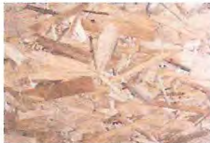
Figura 2.7- Waferboard, virutas no siguen la misma orientación a diferencia del OSB
