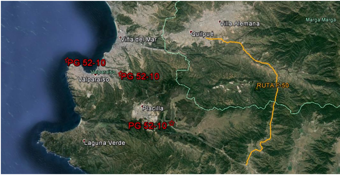
Figura 4.6 – Propuesta de microzonificación del ligante asfáltico por grado de desempeño PG de la Ruta F-50: Lo Orozco – Quilpué, con un 50% de confiabilidad. (Fuente: “Google Earth”).
