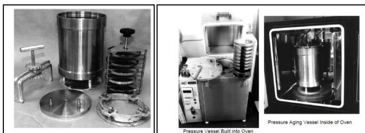
Figura 3.2 – Vasija de envejecimiento a presión. (Fuente: "Manual de Carreteras. 8.302.23. Asfaltos: Método SUPERPAVE de Envejecimiento Acelerado de Ligantes Asfálticos en Cámara de Presión (PAV)").
