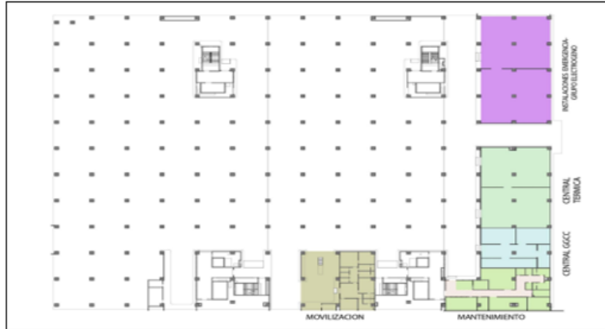
Ilustración 2: Distribución de las instalaciones en subterránea -2 NHCV.
