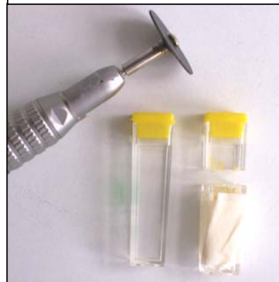
Figura 35. Corte de 1,5 cm realizados a los recipientes
