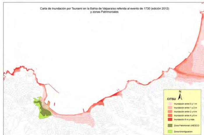
Fig. N° 169. Potencial zona de inundación en relación al área patrimonial de Valparaíso.
