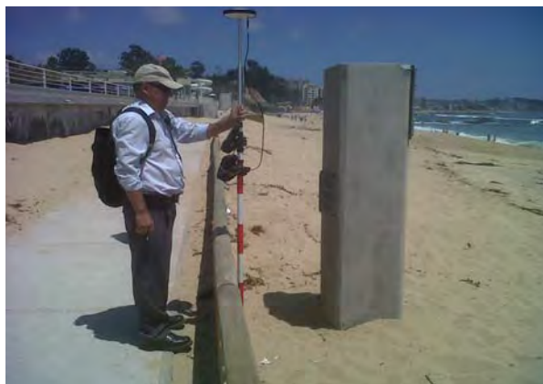
Fig. N° 177. Levantamiento de la línea de la playa.
