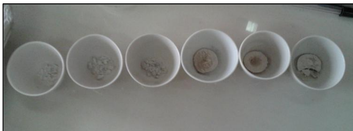
Figura 8: Muestras de HT y HBA para determinación de cenizas.
