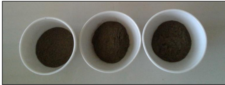
Figura 7: Muestras de HBA para determinación de Humedad.
