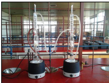
Figura 9: Método de extracción de EE. Equipo Soxhlet.
