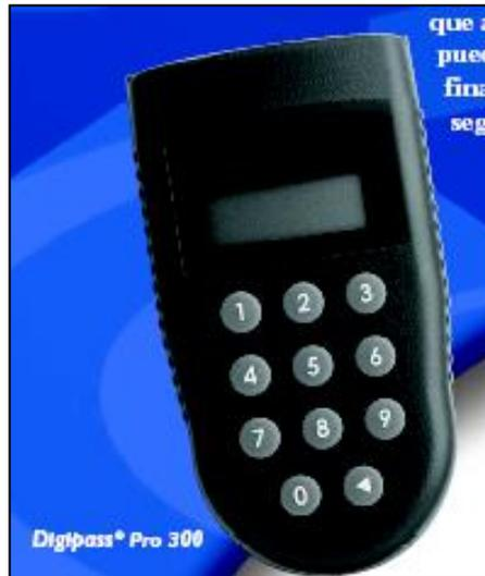
Aquí podemos ver como es un dispositivo Digipass, que es parecido a un teléfono celular. Existen variados tipo pero el utilizado en Enap Refinerías es el que se muestra en la figura. Se puede apreciar la pantalla, los números y una tecla con un triángulo blanco que como se mencionó anteriormente es la tecla APPLI 2, se debe señalar también que el dispositivo está interconectado con la sucursal donde se tiene la cuenta corriente, es decir, Nueva York, EE.UU.
