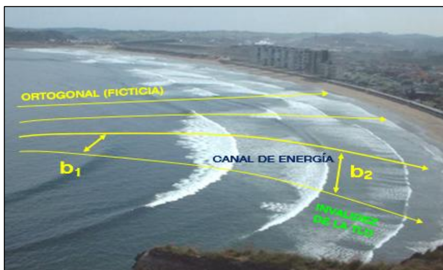
Figura 15: Rayos que definen la trayectoria sobre la cresta de la ola. Fuente: Adaptación del Curso Mecánica de Olas, Universidad de Valparaíso 2010.
