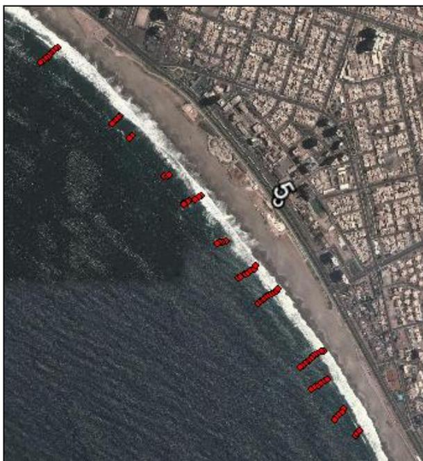
**Figura 5-5: Batimetría de medición datos zona de rompientes en Playa Brava, Iquique.**
