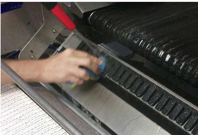
Figura 4.21: Limpieza sensores blando
